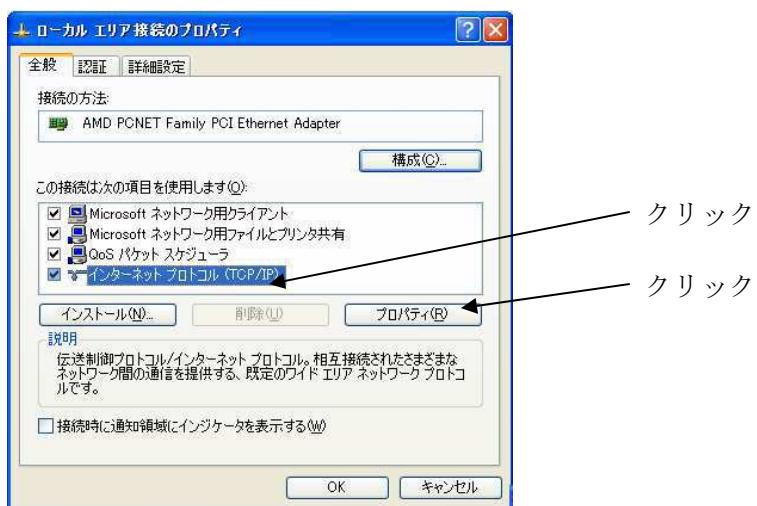
[次のIPアドレスを使う(S)]と、[次のDNSサーバーのアドレスを使う]をクリックして、IPアドレスを[192 168 123 2]に、サブネットマスクを[255 255 255 0]に指定して、[OK]をクリックください。(※その他の欄は空白のままにしてください)
